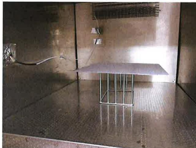
Photo 3 : Echantillon après préparation et éprouvette dans la chambre d'essai d'émission / *Sample after preparation and test piece in emission test chamber*
